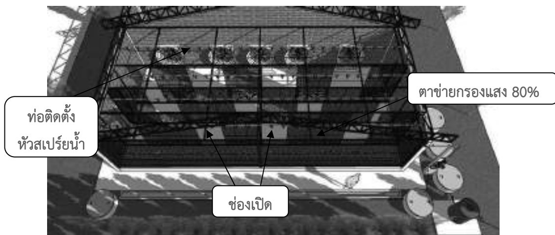
รูปที่ 7.3-20 ลักษณะภายในของระบบกรงกลิ้งมันน้ำกระจายเต็มพื้นที่
